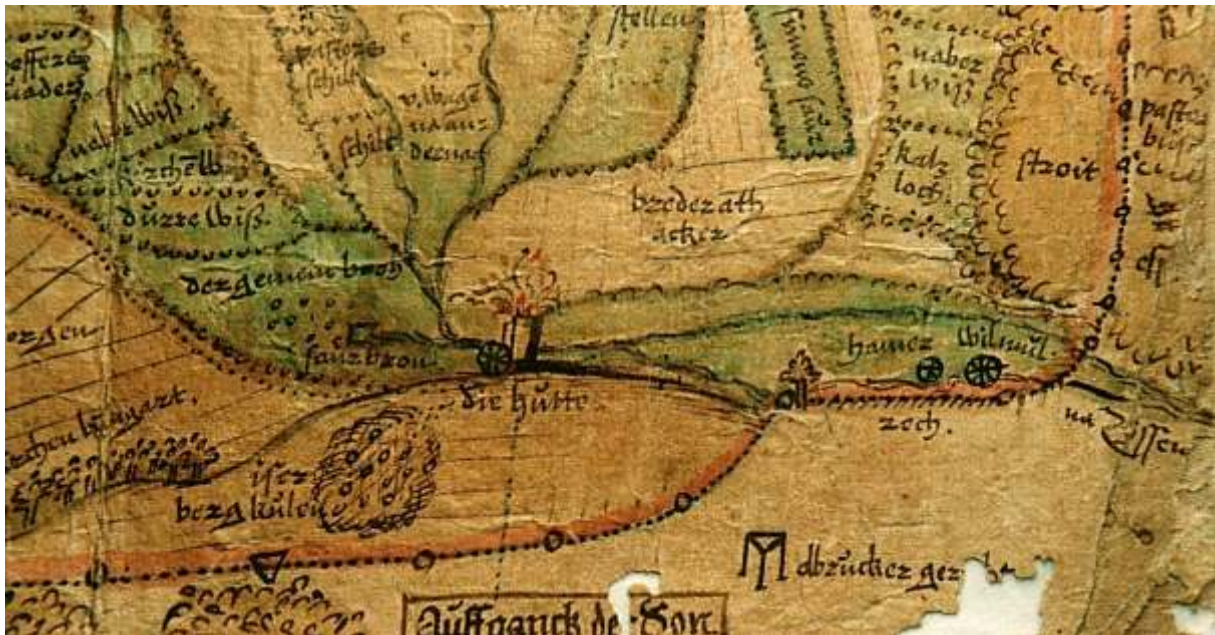
Abb.1 zeigt wesentliche Teile der Wehrer Eisenhütte in dem diesem Ausschnitt einer Karte der „Herlicheit Wehr“, die um 1600 entstanden ist. Von links: die „Iserbergkulen“ ( Eisenbergkaul); (die Eisen-) Hütte mit rauchendem Hochofen; die vor der Hütte vereinigten Bäche; und rechts. der Hamer (der Eisenhammer für die Herstellung von Schmiedeeisen.)
